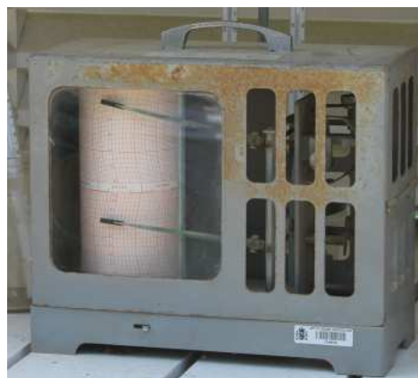
Termohigrògraf. Enregistra la variació de la temperatura i la humitat relativa de forma continua.
