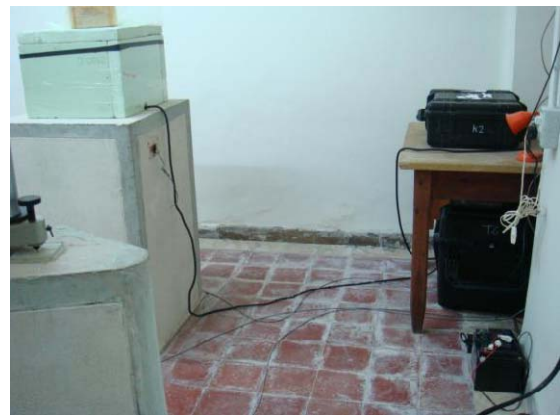
Fig. 10. Detalle de la estación sísmica con sensor Trillium 120 del ICTJA instalada en la cava del OE.
