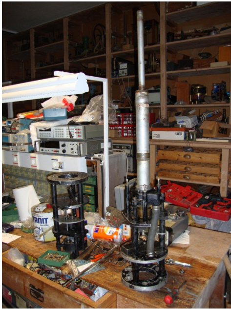
Vista parcial de l'anemocinemògraf Fuess desmuntat al laboratori de l'Observatori.
