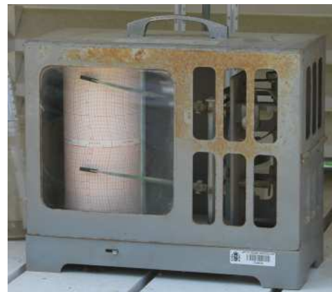
Termohigrograf. Enregistra la variació de la temperatura i la humitat relativa de forma continua. Foto: Observatori de l'Ebre.
